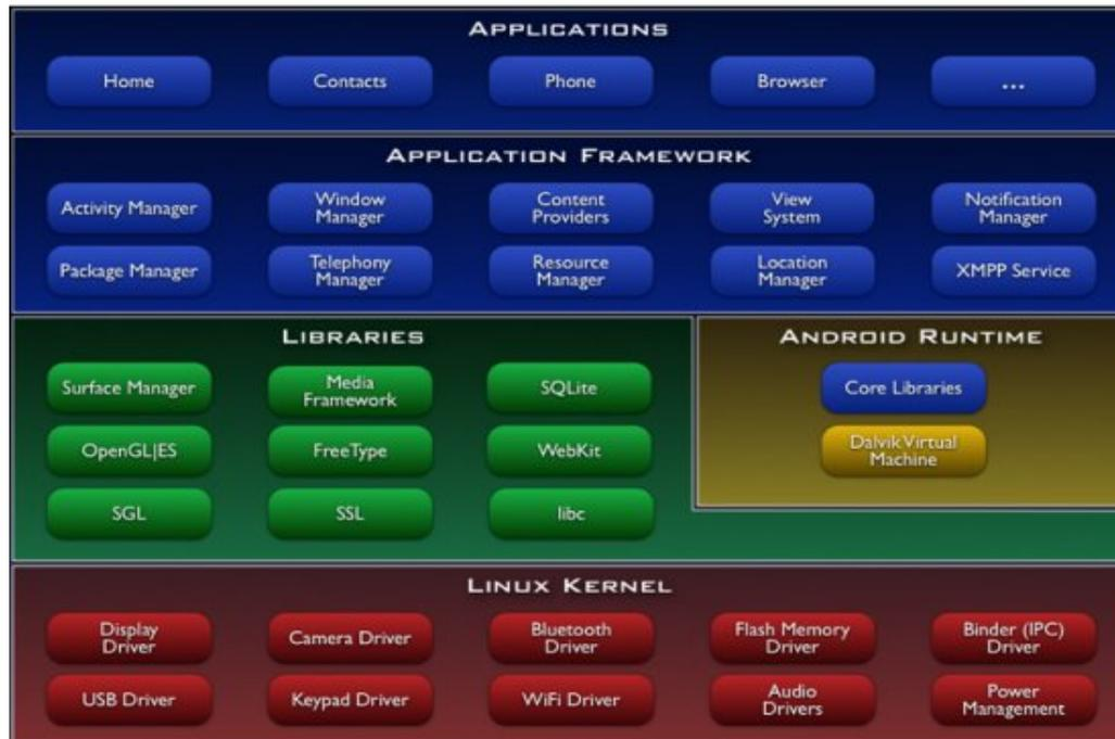
Figura 3.9: Arquitectura del sistema operativo Android
